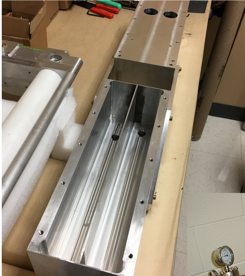
4-Chamber LHe Target
